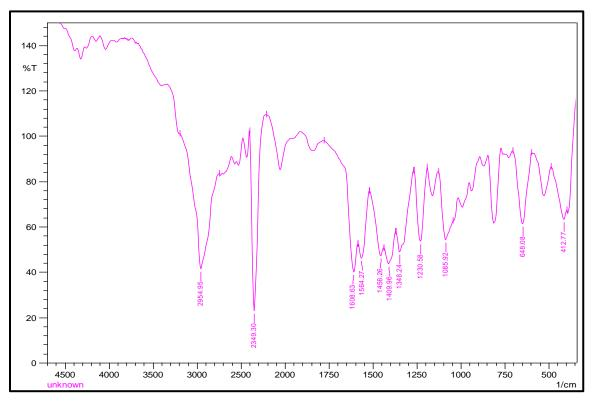
Figure 2.13:. FT-IR spectrum of ENNi(II) complex
