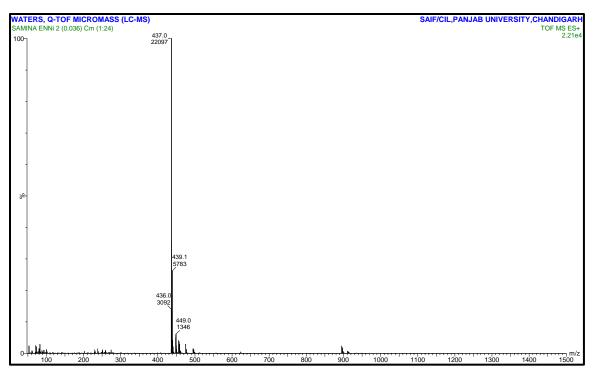
Figure 2.18: LC-MS spectrum of ENNi(II) complex
