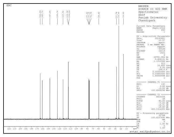
Figure 2.4:. <sup>13</sup>C-NMR spectrum of EN ligand
